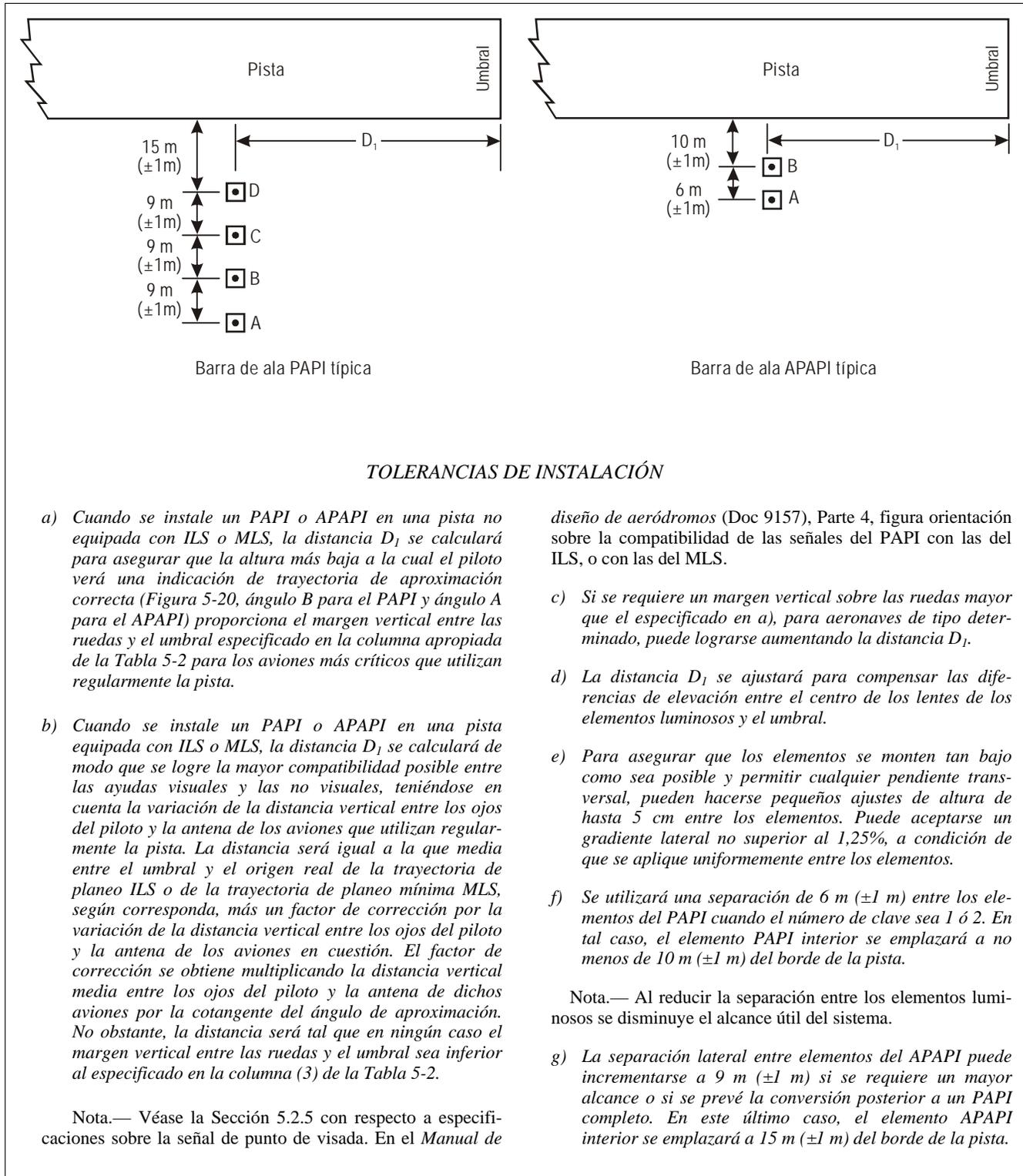
Figura 5-19. Emplazamientos del PAPI y del APAPI
