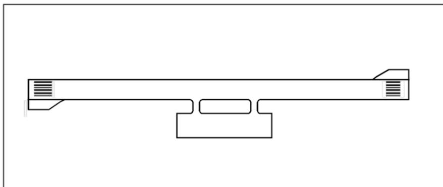
**Figura 3-1. Configuración de una plataforma de viraje típica**
