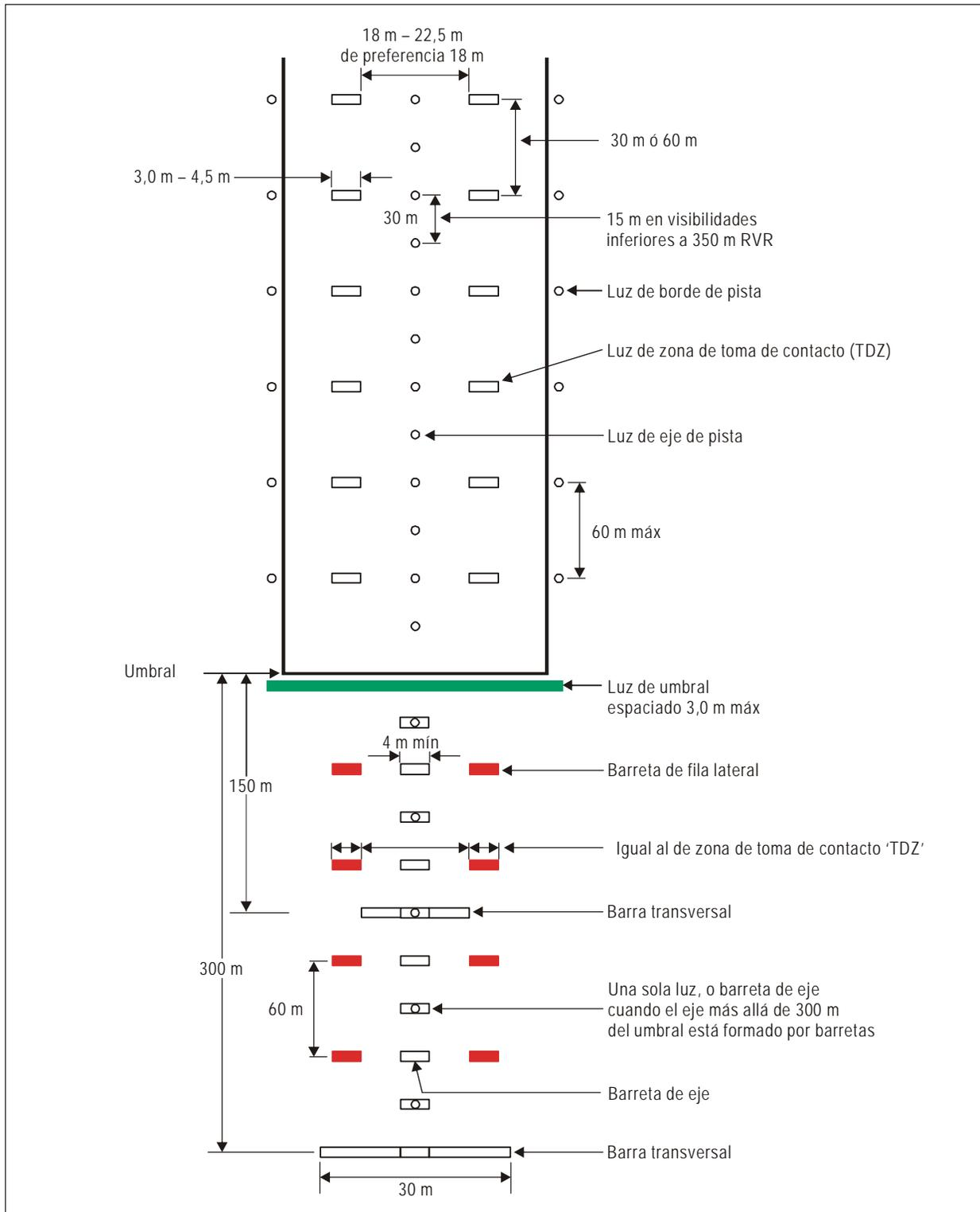
**Figura 5-15. Iluminación de pista y de los 300 m internos de la aproximación en las pistas para aproximaciones de precisión de Categorías II y III, cuando pueda demostrarse que se cumplen los niveles de funcionamiento de las luces especificados como objetivos de mantenimiento en el Capítulo 10**
