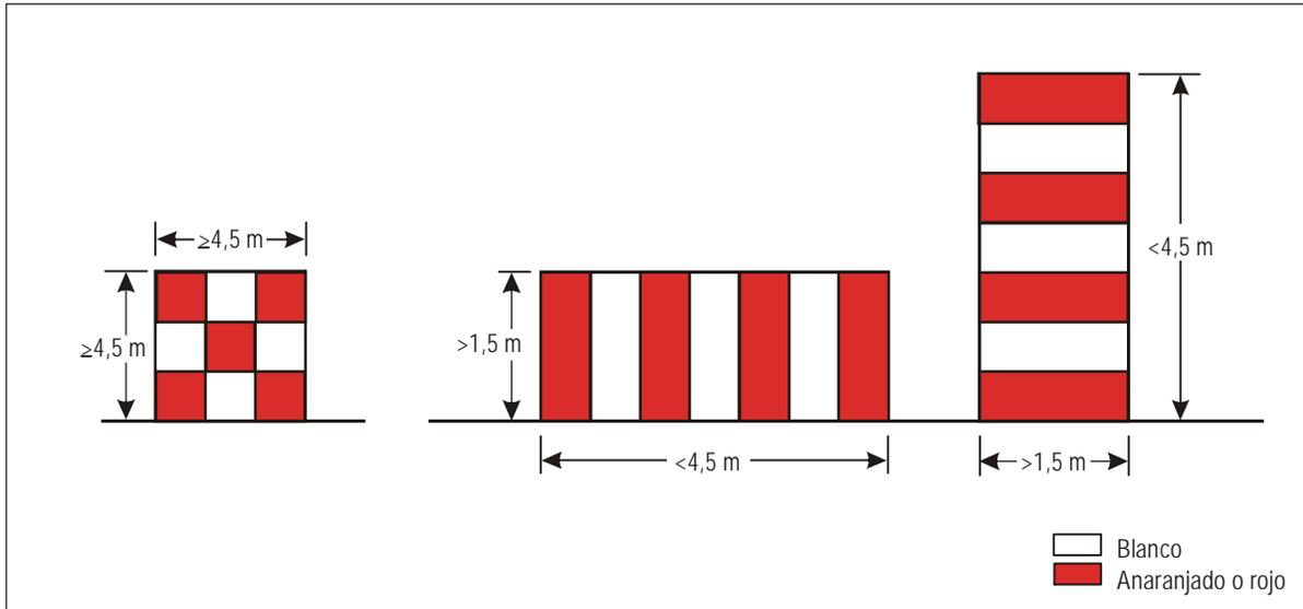
Figura 6-1. Configuraciones básicas del señalamiento de obstáculos
