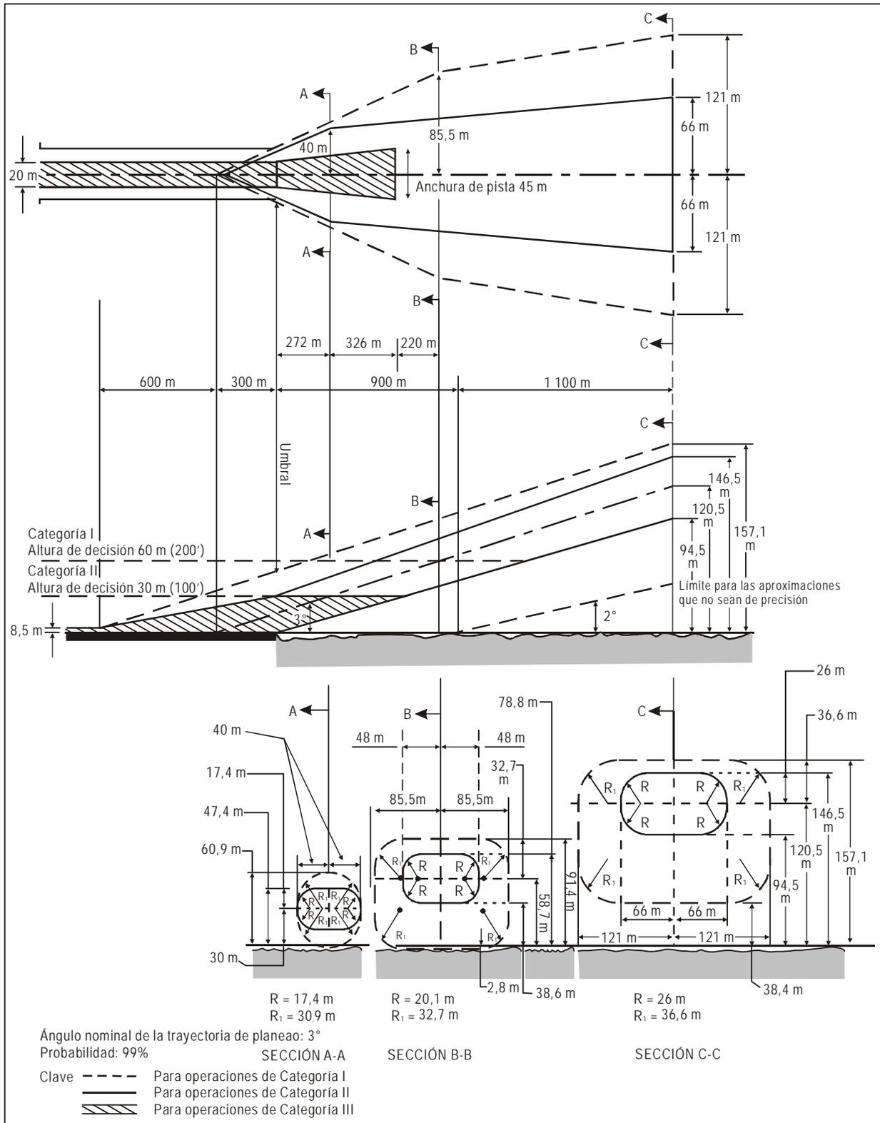
**Figura A-6. Envolturas de trayectorias de vuelo que han de utilizarse en el diseño de iluminación para las operaciones de las Categorías I, II y III**
