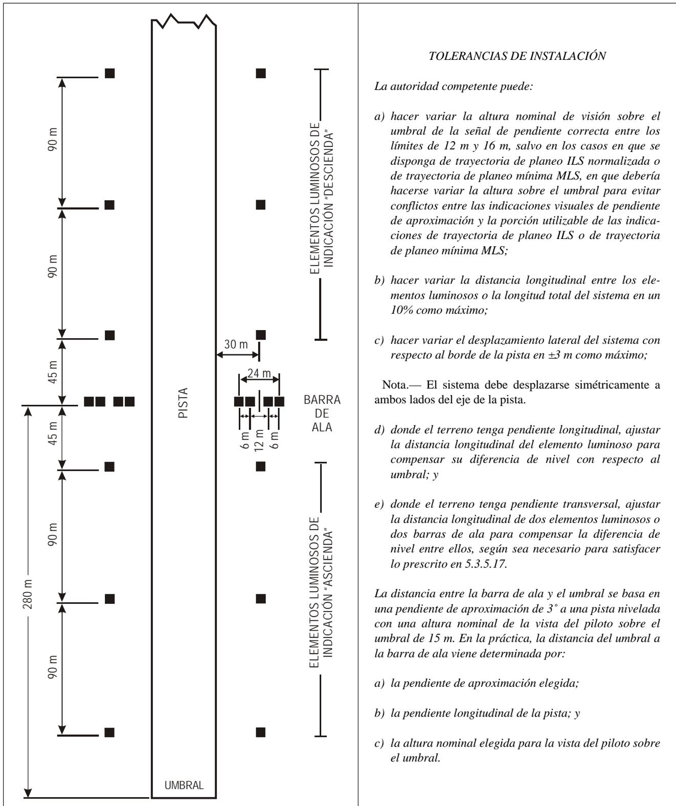
Figura 5-17. Emplazamiento de los elementos luminosos del T-VASIS
