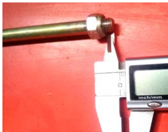
Fig. 3 – Medición de la rosca sobrante.
