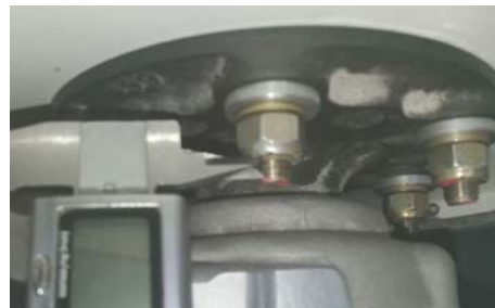
Fig. 4 – Medición de la rosca sobrante con el bulón instalado.
