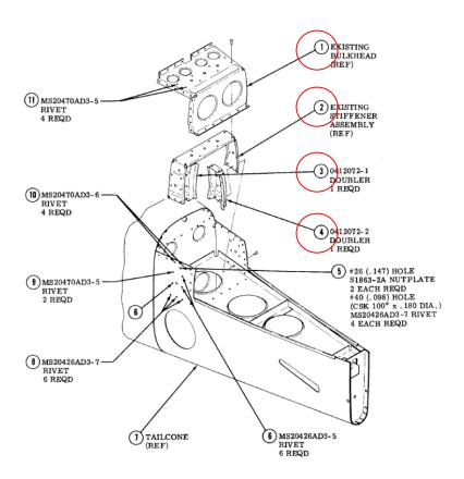
Desde el S/N 17001 al 15072099 (para los 150) y desde el A15000001 al A15000238 (para los A150), está compuesto por el Stiffener Assy. (indicado en la figura como ítem 2) P/N 0412521-3 ó 0432167-1 y la Bulkhead-Stabilizer Attachment (indicado en la figura como ítem 1) P/N 0412177-1.
