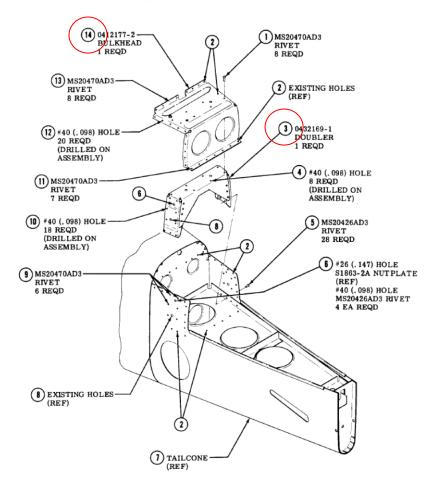
Desde el S/N 15072100 y A15000239 en adelante, está compuesto por un Stiffener Assy, (indicado en la figura como ítem 3) P/N 0432169-1 y una Bulkhead-Stabilizer Attachment (indicada en la figura como ítem 14), P/N 0412177-2.
